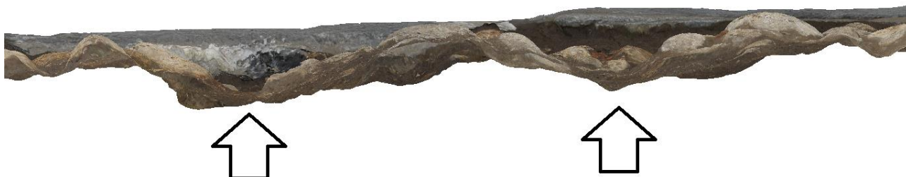
Fot. 51. Zbliżenie na zaznaczone koleiny w przekroju modelu 3D bruku.
